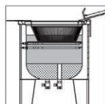
Sistema de dreno 3/4" individual do óleo e da água
